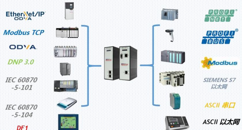
两种以太网可以选择设置在同一个网段或者不同网段。最大支持 20 个 I/O 连接，最多同时可以支持作为 15 个客户端和 15 个服务器，每个客户端最大支持 128 条指令，指令总数最多可达 1920 条。
