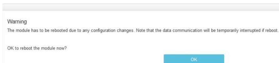
**举例：**配置3个从站，获取从站在线和离线状态到模块内部寄存器，查看模块内部寄存器地址800开始再次点击网页配置模块的部分（需登录后操作），点击Profibus Master---Command，点击Add按钮增加从站状态反馈（如下图），可获取127个从站的状态，Count填写规则要大于127，800表示状态值从内部寄存器800开始放置。
