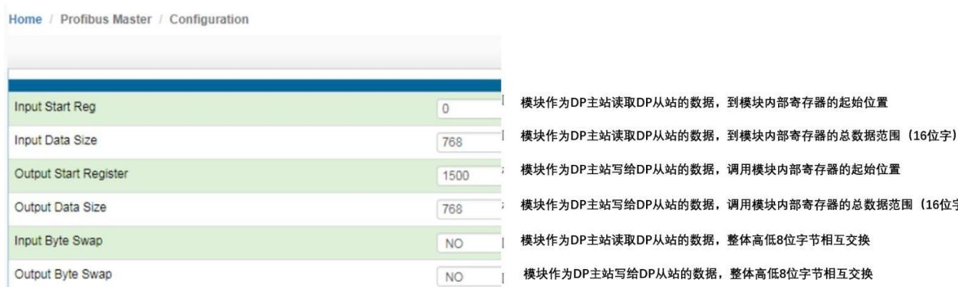
在该窗口中可以配置 Profibus 主站的输入数据量（Input data size）和输出数据量（Output data size），此参数可根据用户的实际应用进行设置。此页面中：
