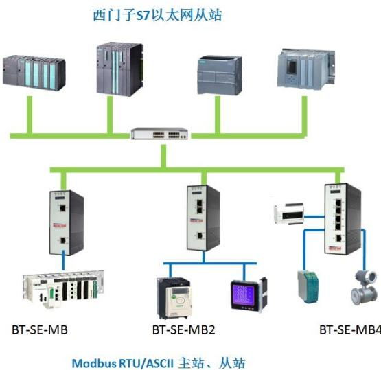
E1 端口 ==配置端口, 支持 Siemens S7 Industrial Ethernet。
