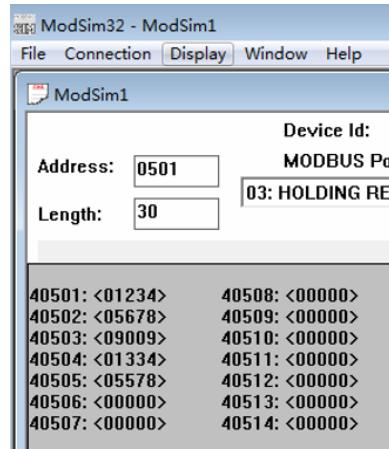
同时，我们在模块的 Modbus RUT 主站的命令区，再添加一条读指令，命令含义：把 MODSIM32 中的 40504–40505 数值读到模块内部数据库 103–104 里面。
