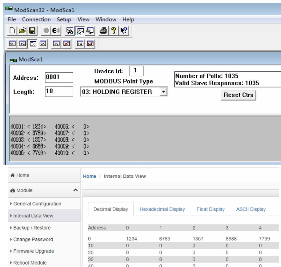
在模块的 S7 以太网一侧，再添加命令，将模块内部寄存器地址 3 开始的 2 个 INT 数据，写给 IP 地址为 192.168.0.3 的西门子 DB1.DBW6 和 DB1.DBW8 里面。
