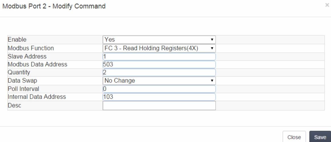
之后返回 S7 以太网主站一侧，到再添加一条 S7 以太网写指令，指令解释如下，把模块第 103–104 寄存器中的 2 个 INT 数据，写给 IP 地址为 192.168.0.3 的西门子 S7-300 系列控制器中，写入到 DB2 数据块里面的字节地址 6–9 的寄存器中。
