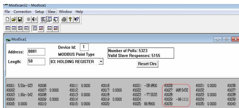
在模块 S7 以太网主站建立一条写指令含义为，从模块内部数据区起始地址 26 开始，调用 2 个 REAL 类型数据，写给 IP 地址为 192.168.0.3 的西门子 S7-300 系列的控制器，写入 DB1 数据块里面的 DBD22 和 DBD26. 保存该指令，重启模块。
