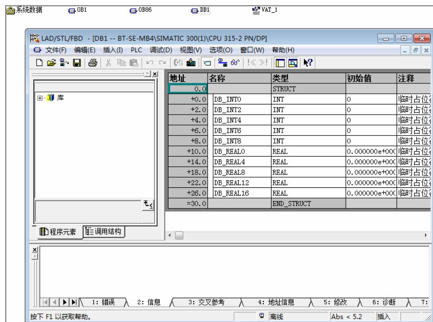
在 DB1.DBW0, DB1.DBW2, DB1.DBW4 里面写点数据。点击 赋值。
