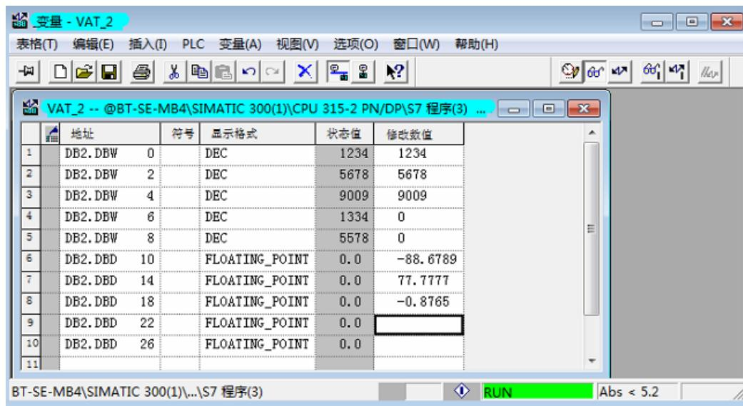
模块中配置西门子 S7 以太网一侧的读指令。指令解释如下，把 IP 地址为 192.168.0.3 的西门子 S7-300 系列的控制器中的 DB2 数据块里面的 3 个 REAL 数据（字节地址 10-21），读到模块第 120-125 寄存器里面。1 个浮点数占网模块内部 2 个寄存器。
