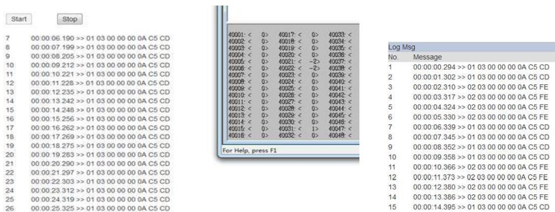
就实现了模块只读取1号从站数值的报文。避免了多个从站中有一个或两个掉线而影响整体Modbus RTU网络变慢的情况。
