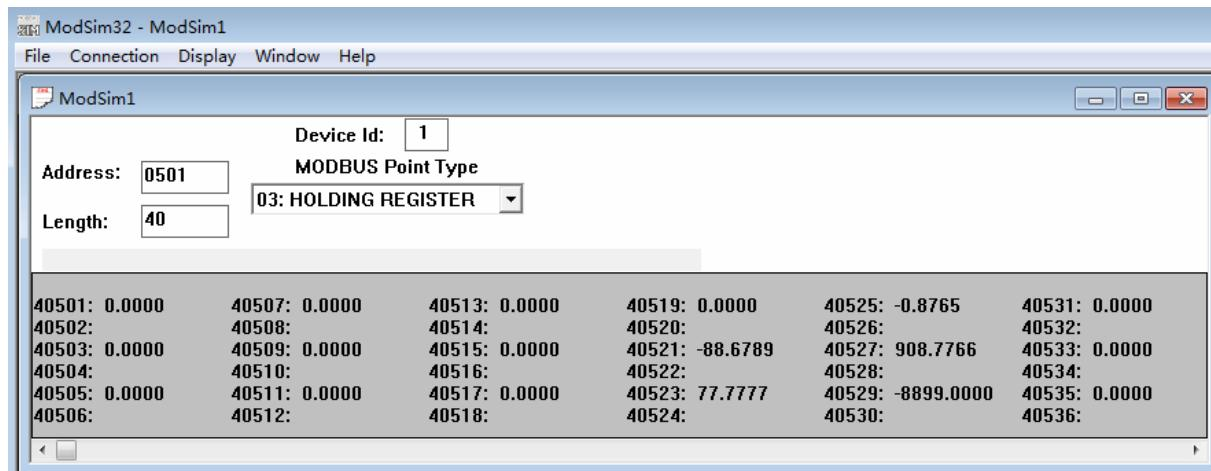
同时，回到模块的 Modbus RTU 主站一侧，增加一条读指令，含义为读取 1 号 modbus 从站的 40527–40530 的 4 个字到模块内部寄存器地址 126–129 中去。
