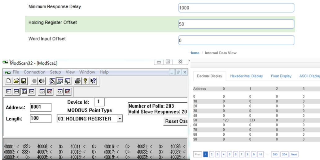
Word Input Offset使用方法: 如果此处偏移量设置成50(如下图)，Modbus TCP主站一侧在3区对30001和30002输入两个数据，数据会直接向后偏移放到模块内部寄存器50-51里面，ModScan32仿真软件不能载入3区的数据，请以现场设备实际数据区域来填写。
