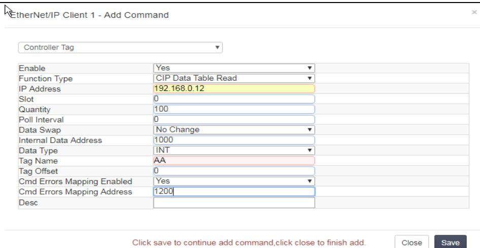
举例一：如上图，读取 IP 地址为 192.168.0.12，CPU 位于 0 槽位的 L63 CPU 里面的全局变量标签数组 AA，数组是 INT 格式，数量 100 个 INT(每条命令最大 100 个 INT, 或者 50 个 DINT/REAL)，放到模块内部寄存器 1000-1099 里面，如果命令检测不到 AA 的数组有 100 个 INT 或者没有 AA 数组，或者 IP 地址不对，槽位不对等，就会在模块内部寄存器 1200 的位置报一个非零值，显示这条命令有错误，工程师可以使用 Cmd Errors Mapping 反馈来查看所连接设备的状态。（注：对于读来说 Data: Type 始终是 INT, 不可修改，但是会随着数组的类型自动调整）
