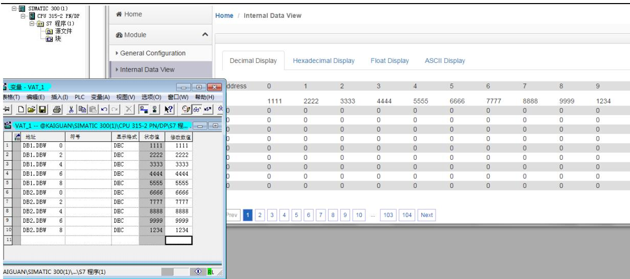
配置模块做 EtherNet/IP Class 1 Server 从站，根据下图分配输入输出寄存器区域
