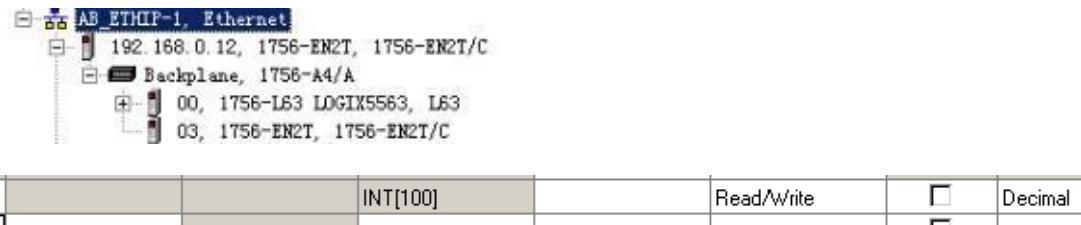
读取 IP 地址为 92.168.0.12，CPU 位于 0 槽位的 L63 CPU 里面的全局变量标签数组 BB，数组是 REAL 格式，数量 50 个 REAL(每条命令最大 100 个 INT, 或者 50 个 DINT/REAL)，放到模块内部寄存器 1100-1199 里面，如果命令检测不到 BB 的数组有 50 个 REAL 数据，或者 IP 地址不对，槽位不对等，就会在模块内部寄存器 1201 的位置报一个非零值，显示这条命令有错误，工程师可以使用 Cmd Errors Mapping 反馈来查看所连接设备的状态。
