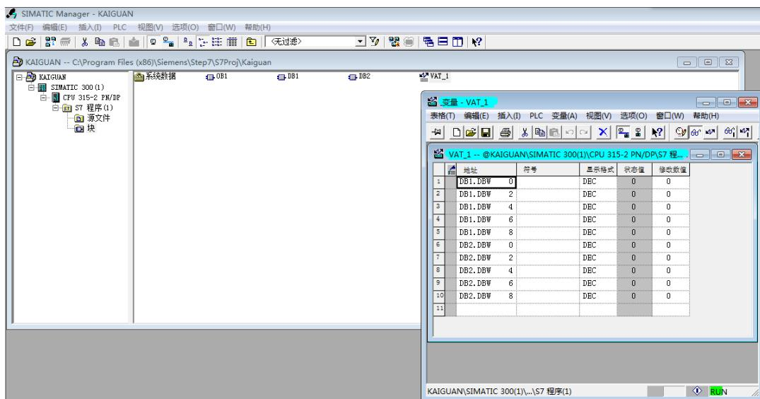
配置 S7-Ethernet Client 主站指令，点击 S7-Ethernet Client----Commands 建立两条指令
