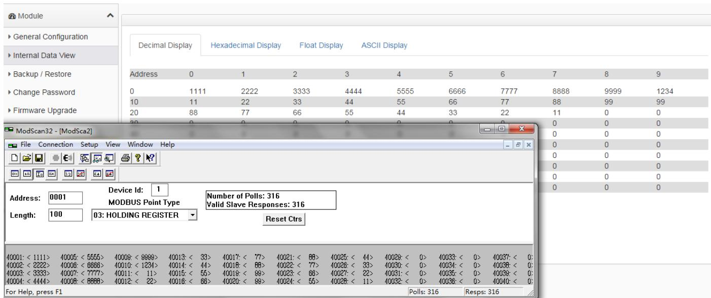
同时，由于在之前的测试中，已经对于模块内部数据区和罗克韦尔 PLC 之间地址区之间建立了 CIP 映射，所以从仿真软件地址区 40011 到 40028 写到模块内部寄存器地址 10-27 的数据，就通过模块被读取到了罗克韦尔 PLC BT\_ESM\_P:0:I.Data[10]-BT\_ESM\_P:0:I.Data[27]里面。
