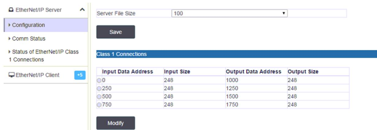
在 Logix50000 内建立 CIP 输入输出数组，具体内容请见前文“配置模块做 EtherNet/IP server”
