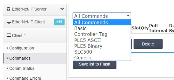
Basic 命令用于罗克韦尔 PLC-5, ControlLogix 数据的读写;
