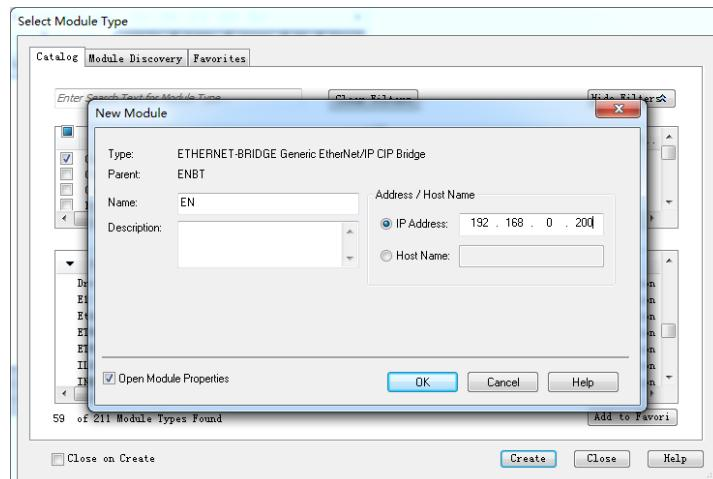
在 Generic EtherNet Bridge 下添加一个新模块，再添加一个新的 CIP-Connection.
