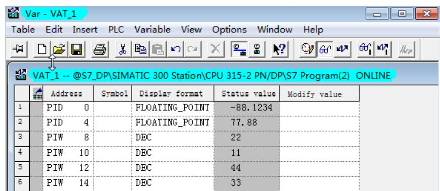
从以上 3 幅图可以看出，因为照顾了浮点数传输正确，所以导致传输到西门子 PLC 的整型数也跟着交换了。这时需要两边对应点表，只有再通过 PLC 程序处理了。
