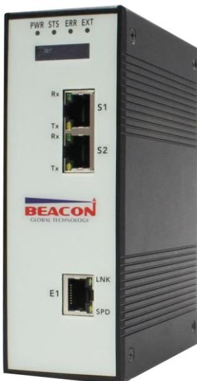
Beacon Global Technology 的新型 Modbus TCP- IEC 60870-5-103 串口通讯网关模块 BT-MT-103-S, 支持在 Modbus TCP 和 IEC 60870-5-103 网络中的设备之间的双向数据交换, 最大 20,000 个字节数据交换区。
